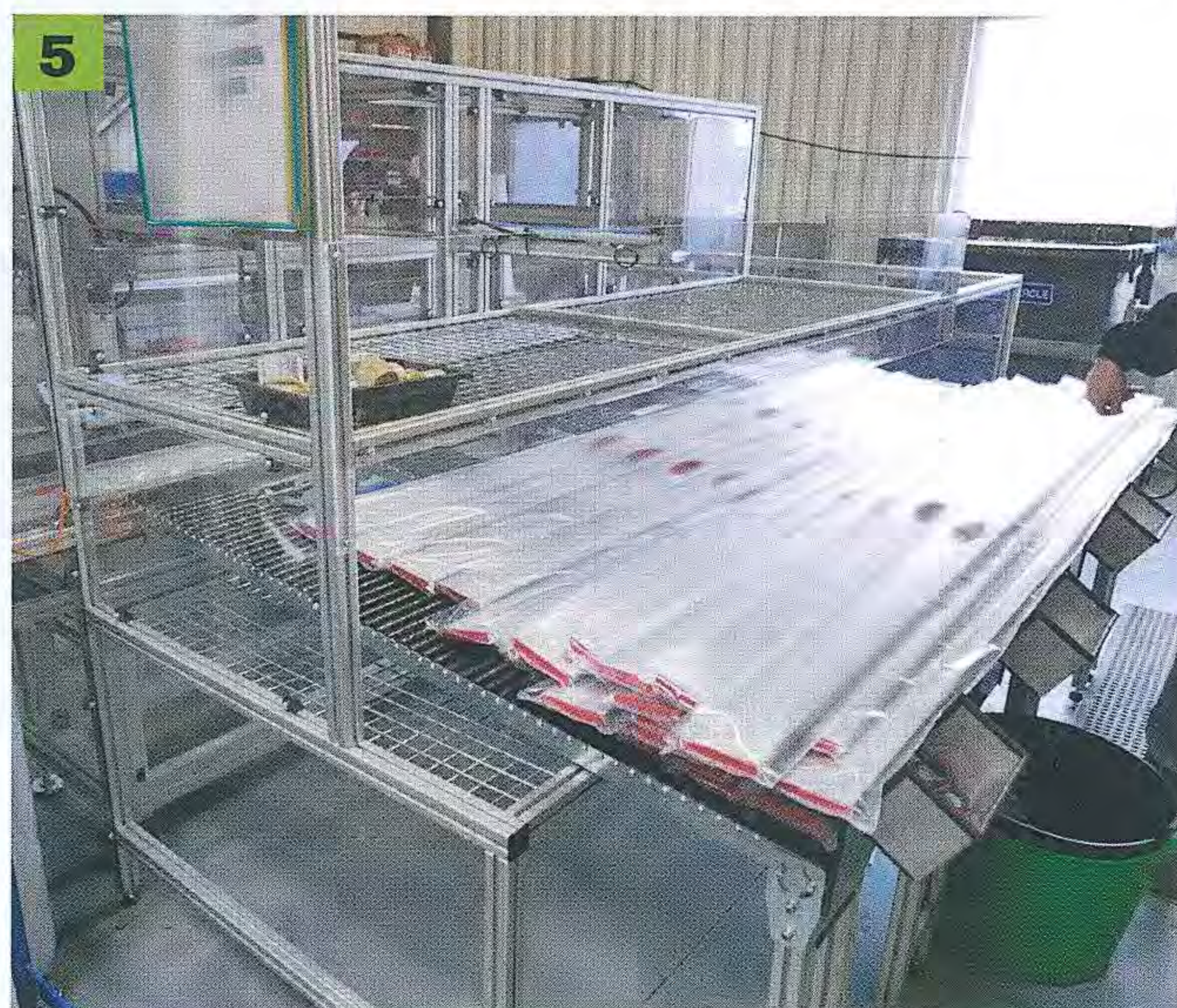
5 En fin de ligne, les règles à niveau sont conditionnées de façon automatique.
