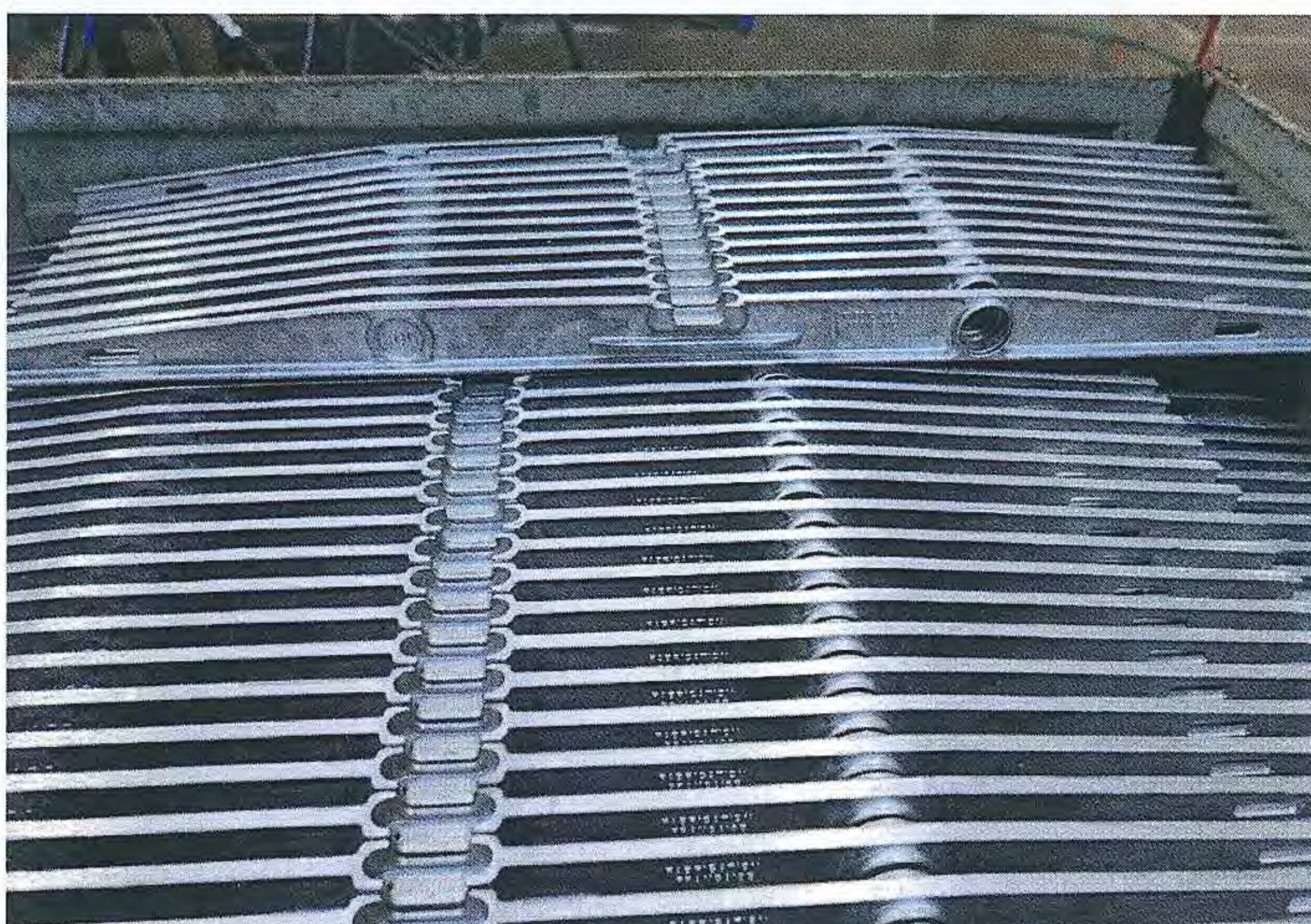
Etat final des niveaux après fonderie. Une vérification est effectuée par échantillonnage pour chaque étage de produits fabriqués, par contrôle visuel après un léger fraisage de la semelle. Pour la traçabilité, un repère indiquant le mois de moulage apparaît au fond du logement devant accueillir la fiole horizontale.
