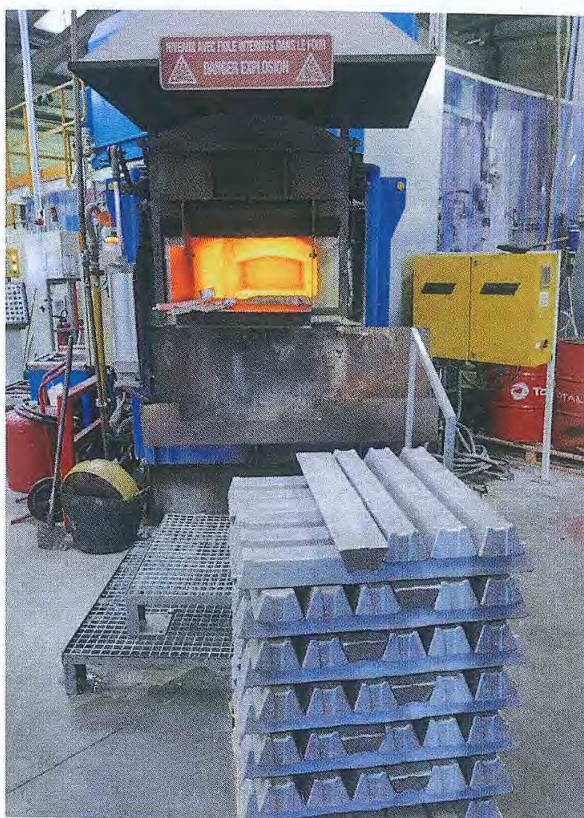
La première étape de la fabrication d'un niveau en aluminium sous pression est la plongée dans le four des lingots d'aluminium et des sous-produits de fonderie (pièces non conformes, talon de lavage, bras d'alimentation). Porté à 690°C, l'aluminium en fusion est prélevé par une louche – son inclinaison détermine le volume de matière – pour être amené à une chambre intermédiaire d'où il est expulsé vers le moule par un piston.
