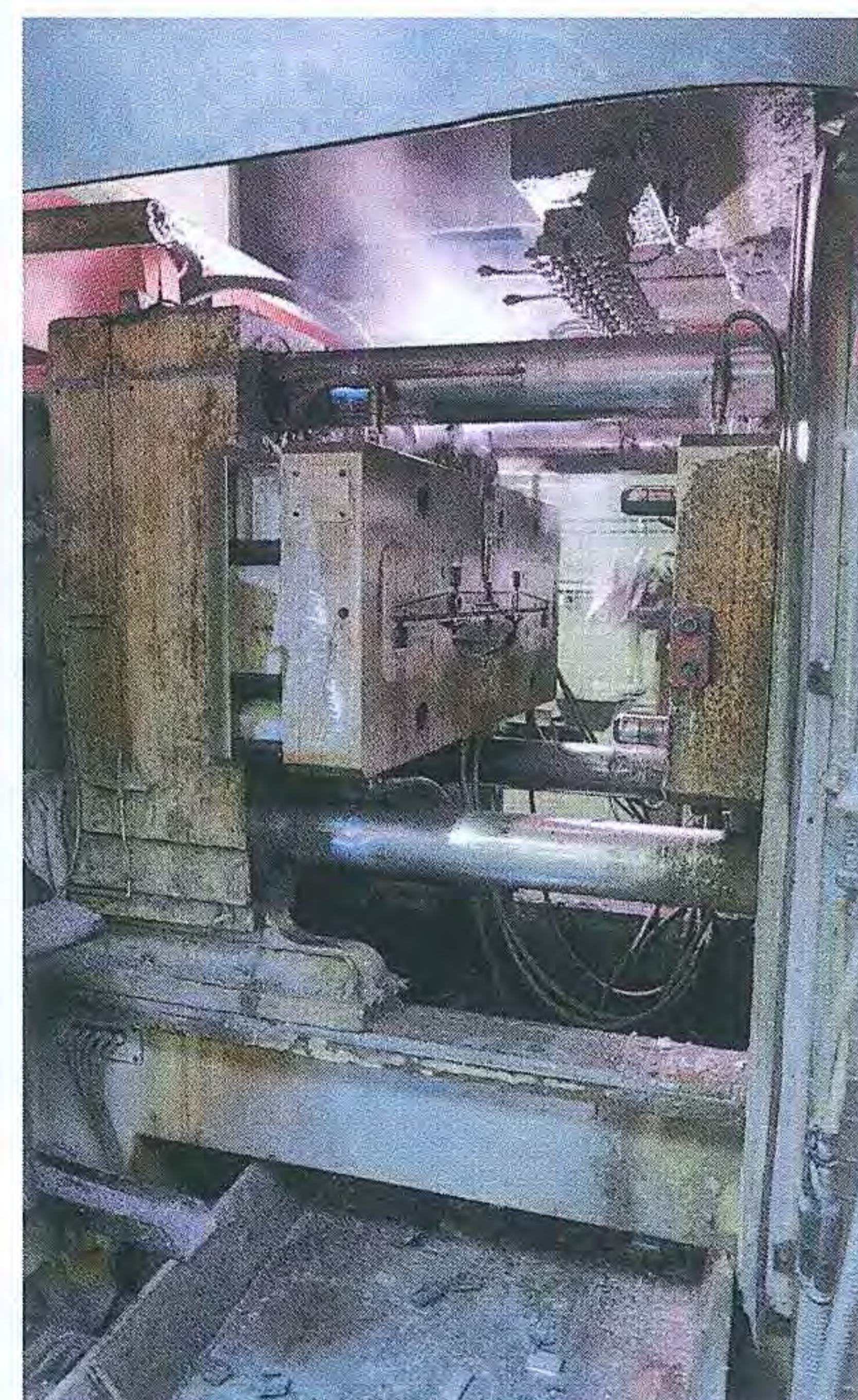
La pièce de fonderie, niveau trapézoïdal ou niveau rectangulaire, est moulée dans la presse. Entre chaque passe, l'outillage fait l'objet d'une pulvérisation d'un liquide démoulant et refroidissant pour lui conserver toutes ses qualités (poteyage).
