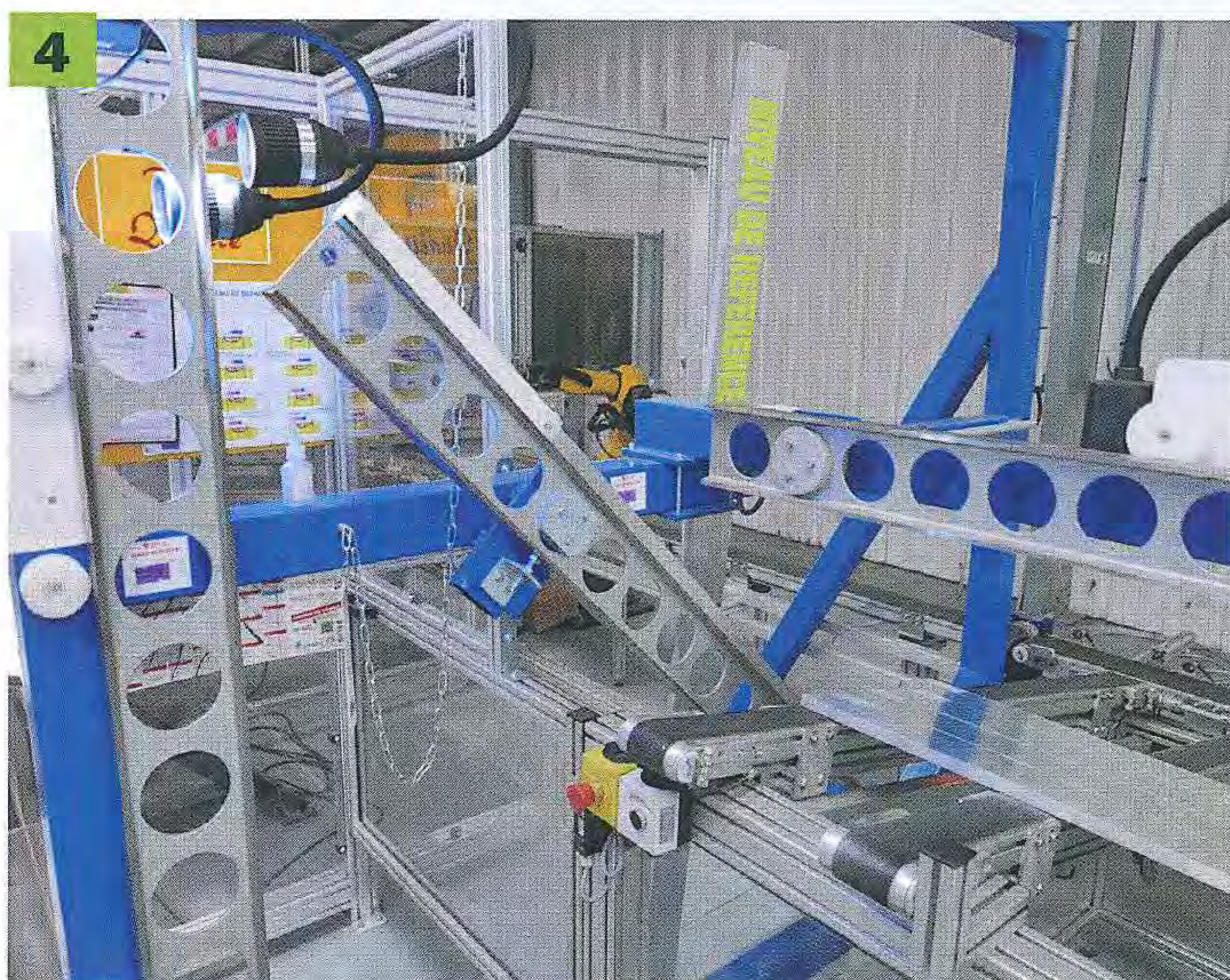
4 Après montage des règles, l'alignement de leurs fioles est vérifié sur trois bancs, un horizontal, un vertical et un dernier incliné à 45°.
