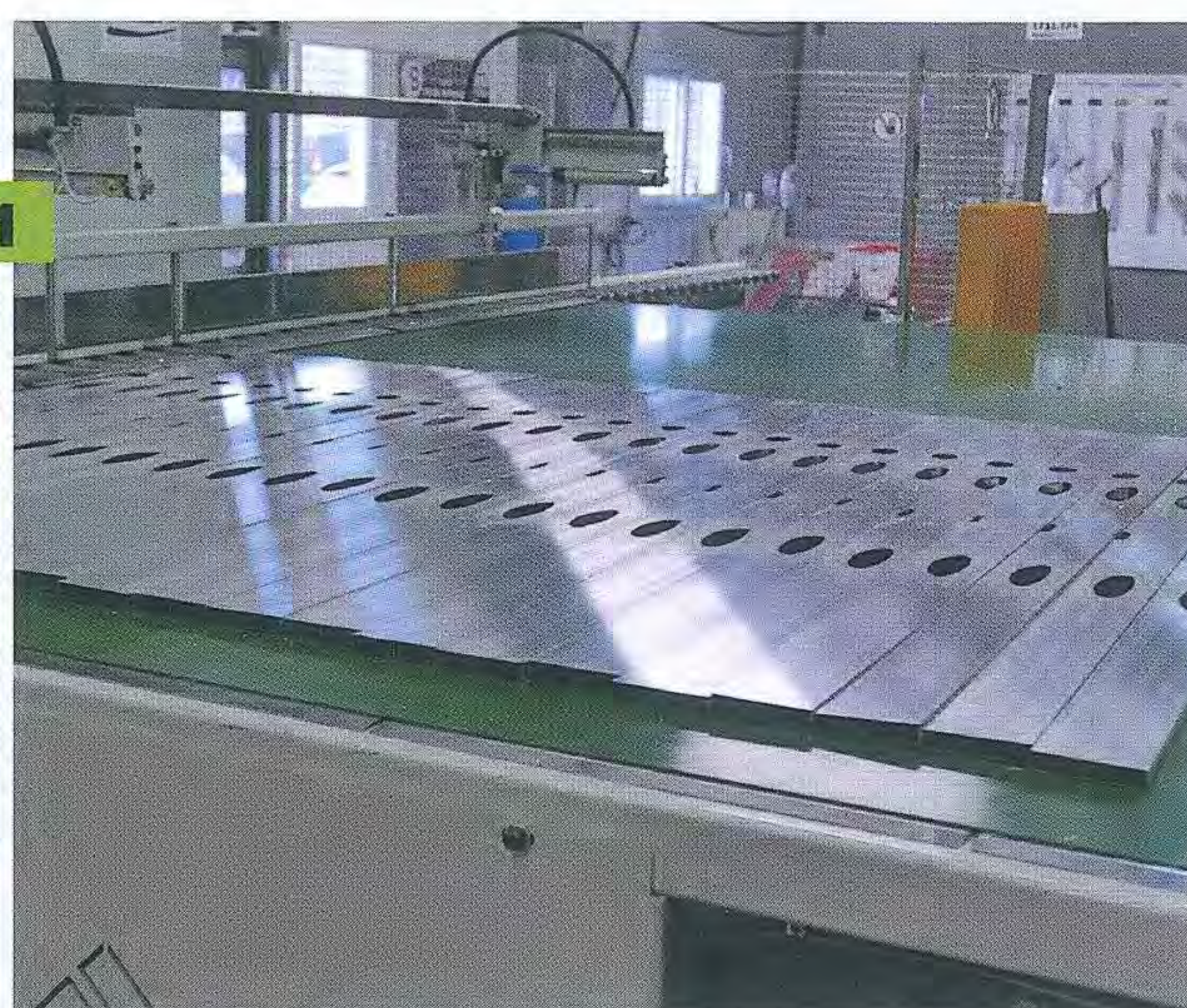
1 Le centre d'usinage peut travailler sur chaque face et sur chaque angle de profilés de toutes formes (plat, I, H, cranté, tube...) faisant jusqu'à 6 mètres de long.
