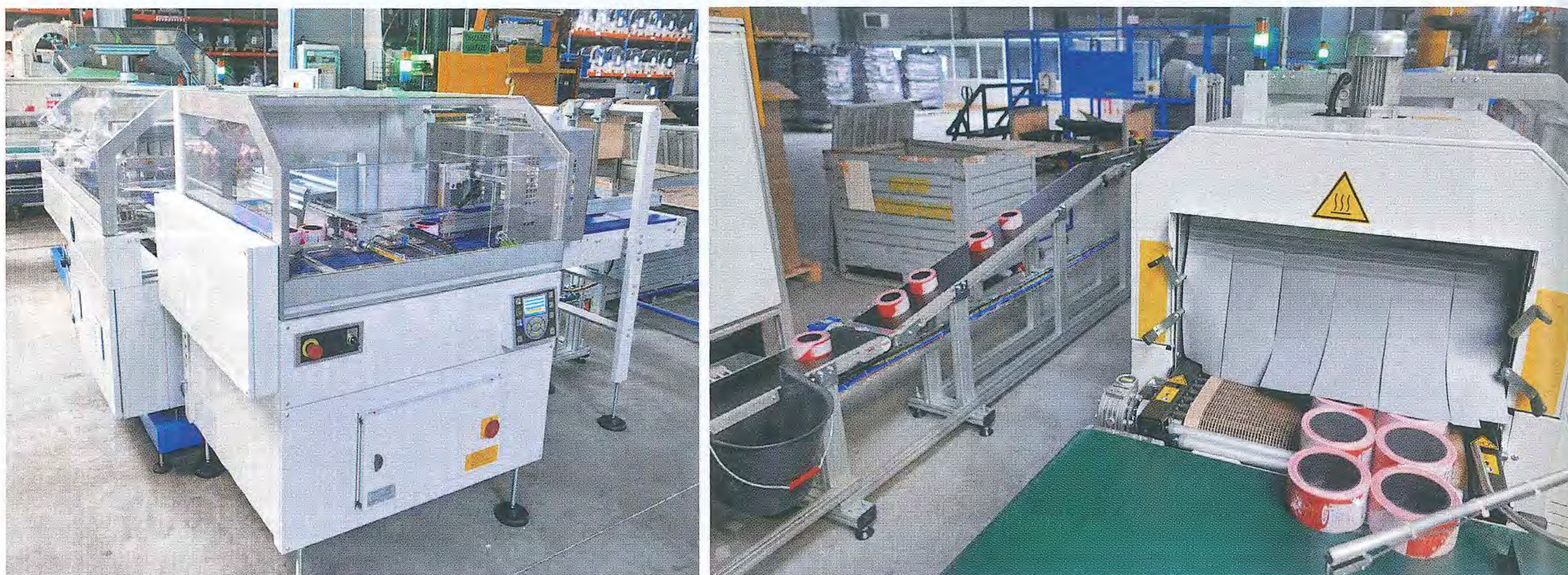
Sofop Taliaplast a modernisé sa chaîne de conditionnement à haute cadence de ses rubans avec une nouvelle machine qui étiquette et emballe directement. Elle comporte un groupeur de produits afin de pouvoir préparer des lots.
