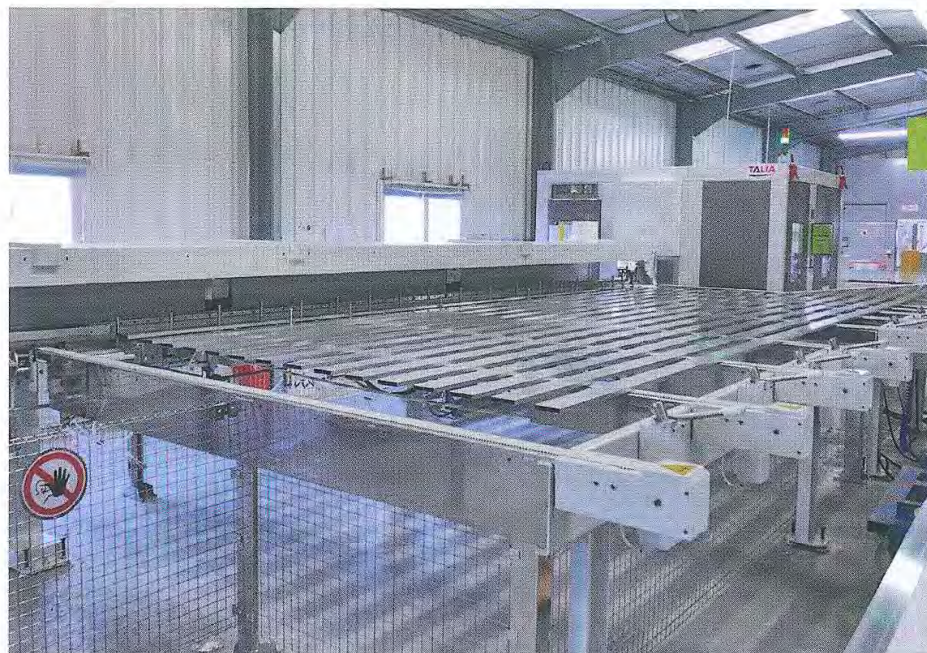
1 Le centre d'usinage peut travailler sur chaque face et sur chaque angle de profilés de toutes formes (plat, I, H, cranté, tube...) faisant jusqu'à 6 mètres de long.
