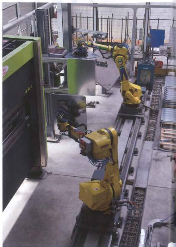
Pour la fabrication des panneaux de signalisation temporaire, le robot Mario au premier plan s'approvisionne en plaques galvanisées sur une palette et les positionne sur un gabarit où est contrôlée l'épaisseur de la tôle. Après un recalage de la prise pour la positionner au dixième de millimètre près, la tôle est amenée à une plieuse qui effectue le pliage des bords – asservi au robot. Dans la continuité, le robot Luigi reprend la plaque et vient arrondir les coins et cisailer le surplus de matière pour former les angles. Le robot gère également la palettisation. Dans un autre atelier à la température contrôlée, les films signalétiques seront collés sur les panneaux.
