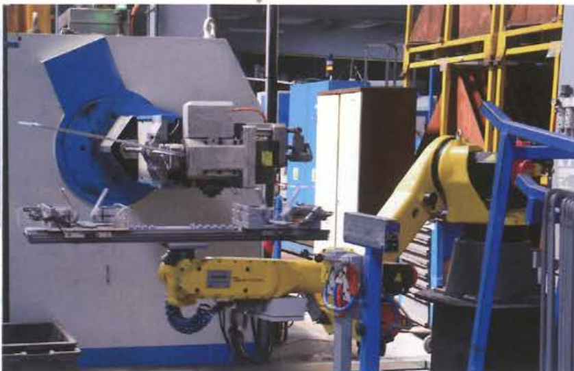
Les pieds de panneaux sont également façonnés sur une machine totalement automatisée.
