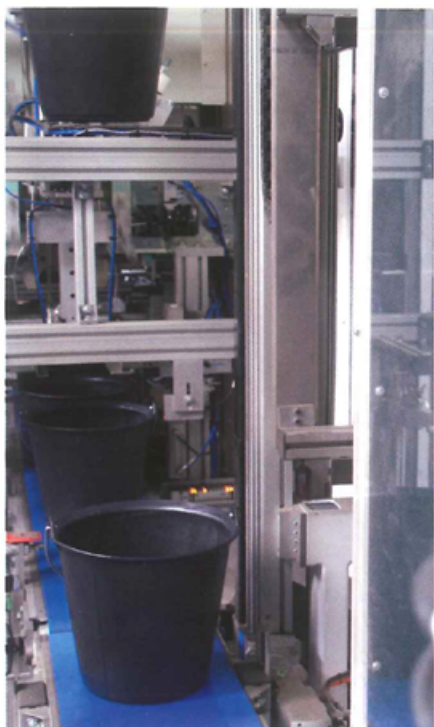
Dans un processus totalement automatisé, les seaux injectés refroidissent sur un tapis avant d'être équipés de leur anse, étiquetés et empilés. Ici un détail de la production des seaux de 13 litres.
