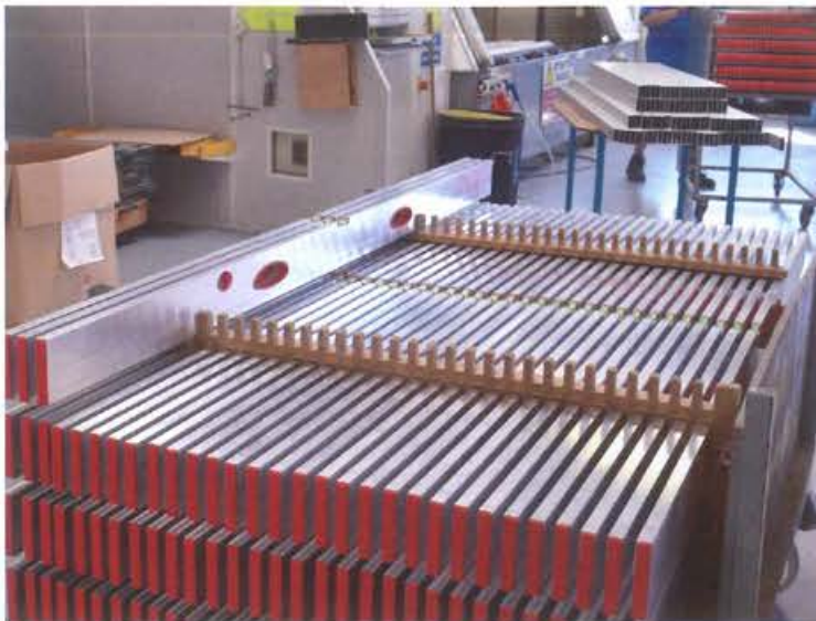
Pour ses règles à niveau, Sofop taliaplast® peut utiliser des fardeaux qui font jusqu'à 6 m de long. D'une façon globale, 90% de la matière première provient d'Europe.
