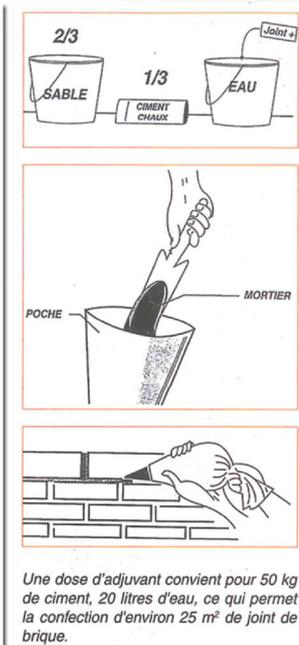
Une dose d'adjuvant convient pour 50 kg de ciment, 20 litres d'eau, ce qui permet la confection d'environ 25 m<sup>2</sup> de joint de brique.
