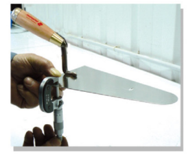
contrôle épaisseur lame
